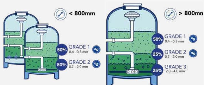
**Für kleinere Filter (< Ø 800 mm Durchmesser) oder alle Filter mit Düsenböden, unabhängig von der Filtergrösse:**
